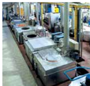
Fornos e equipamentos para a linha de banhos de sais
